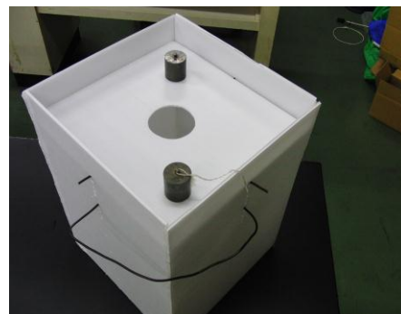
図 3 プラスチックダンボール空気砲
