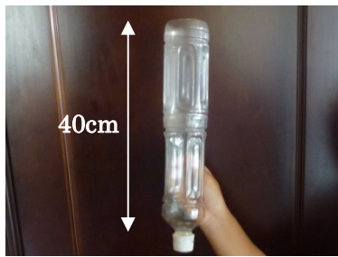
写真 2 透視度計の全体写真。ペットボトルを使って作った。
