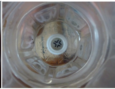
写真 3 透視度計を上から見たところ。上から水を入れて真ん中の×印が見えるまで下のキャップを緩めて水を捨てていき、見え始めた時の深さを透視度とした。
