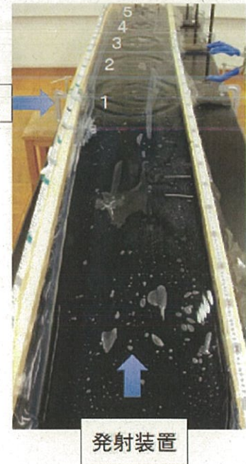
図 4:実験での水切りの様子 写真中では5回跳ねている
